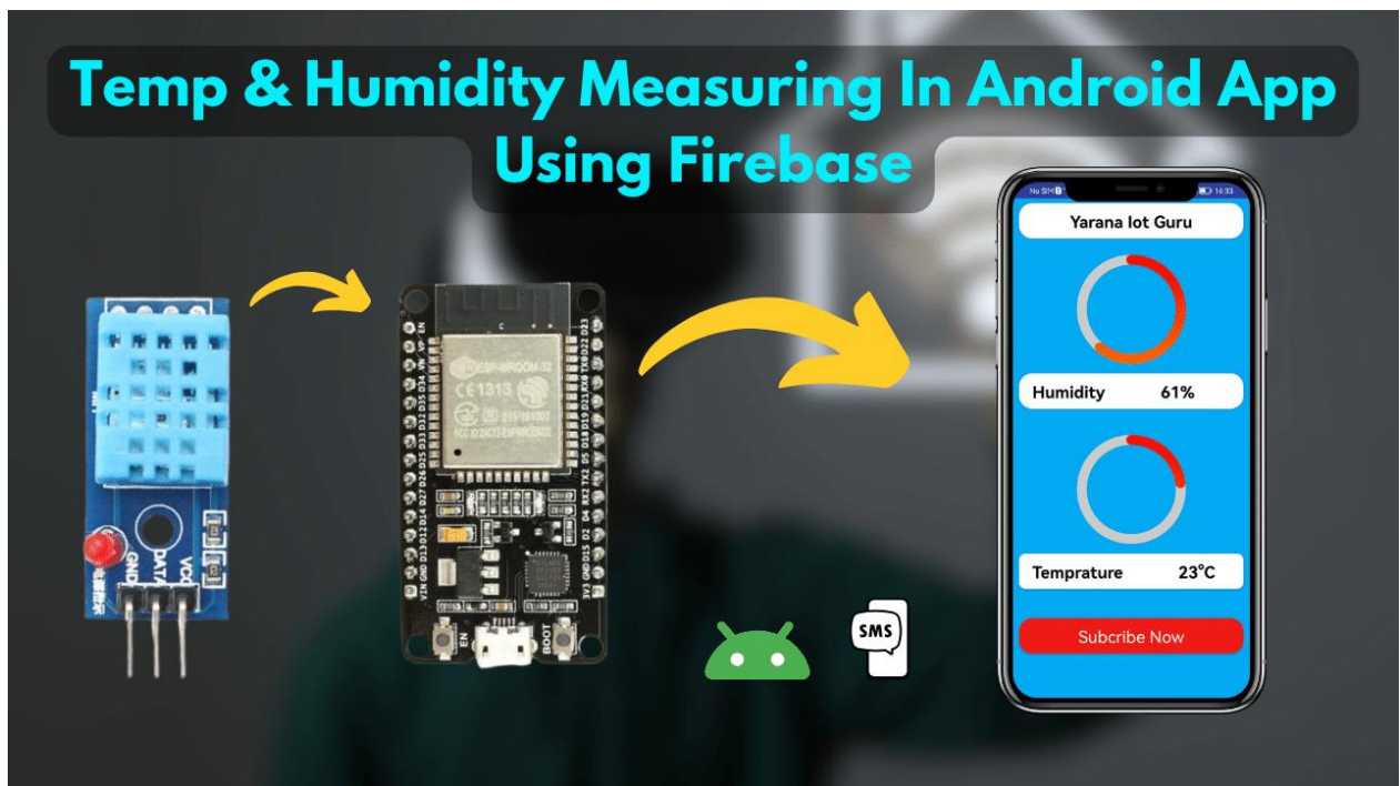
Рисунок 2.1 – Структурна схема системи моніторингу параметрів мікроклімату приміщення на основі ESP32, Firebase та Android
