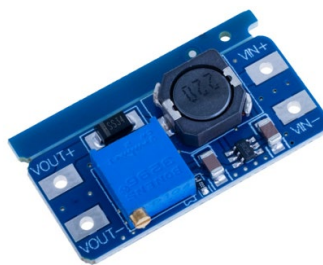
Рисунок 2.3 – Готовий підвищуючий DC-DC модуль MT3608 для практичного аналізу Boost-топології [6]
