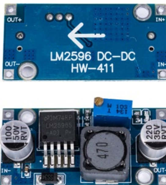
Рисунок 2.2 - Готовий понижуючий DC-DC модуль LM2596 для практичного аналізу Buck-топології [5]
