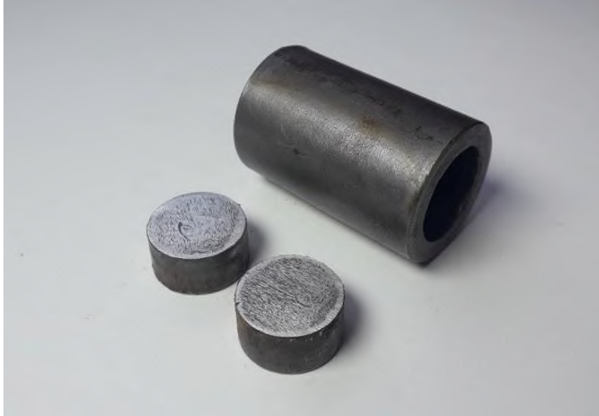
Рис. 2.9. Загальний вигляд прес-форми для виготовлення зразків на стиснення
