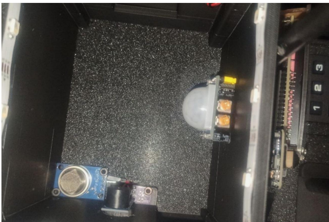
Рисунок 3.6 – Монтаж сенсорів і виконавчих елементів у конструкцію стін моделі будинку
