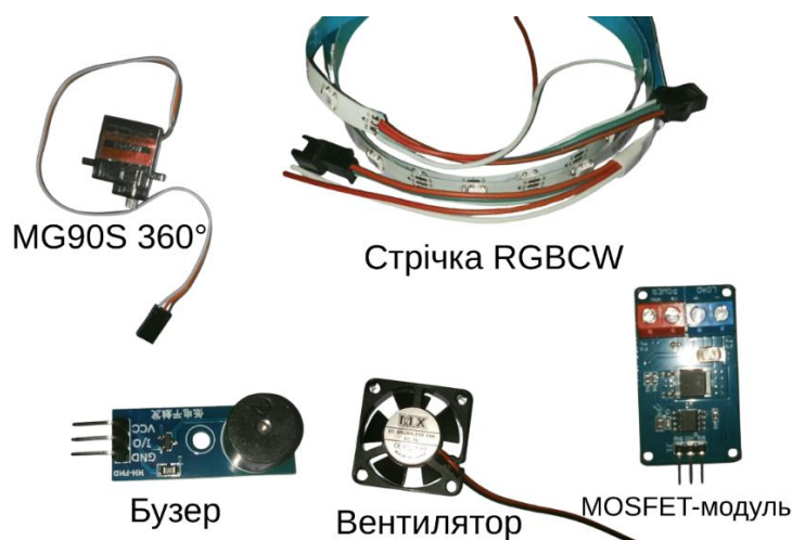
Рисунок 2.9 – Виконавчі елементи, які обрано для реалізації системи Domovuk
