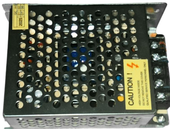
Рисунок 2.11 – Блок живлення DC 5V 8A
