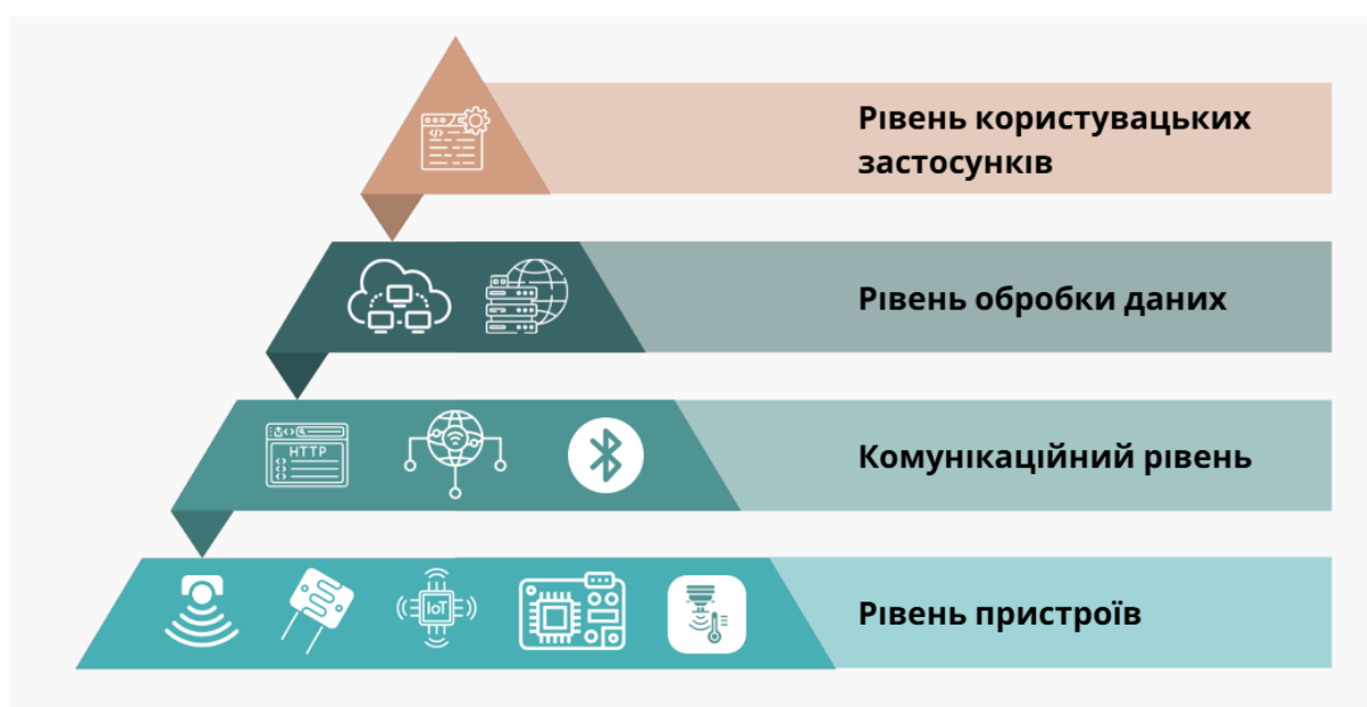
Рисунок 1.2 – Схема багаторівневої архітектури IoT
