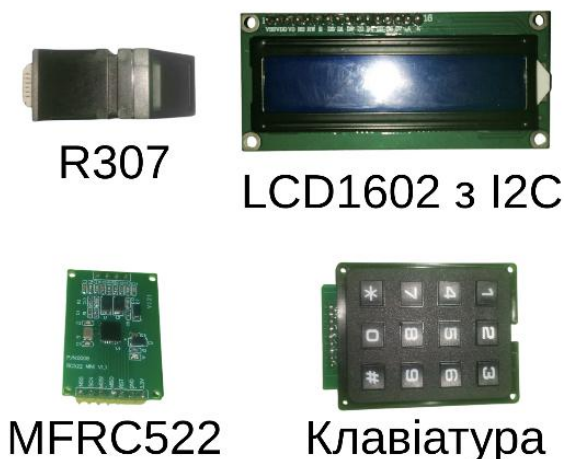
Рисунок 2.8 – R307, MFRC522, матрична клавіатура та дисплей LCD1602
