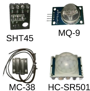
Рисунок 2.7 – Датчики SHT45, MQ-9, MC-38 та HC-SR501
