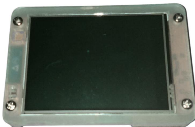
Рисунок 2.10 – Сенсорний дисплей ESP32-2432S028R
