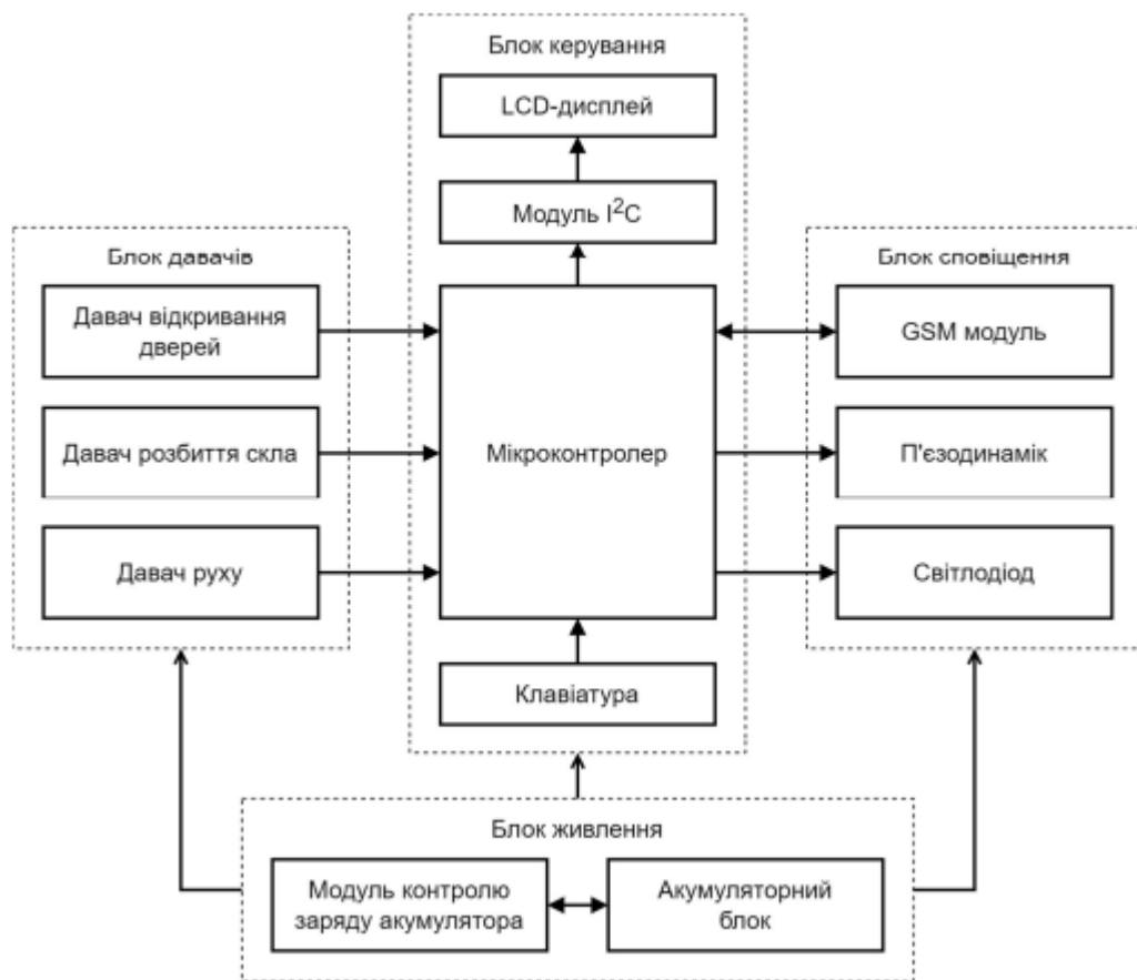
Рисунок 1.5 – Структурна схема системи побутової охоронної сигналізації [19]
