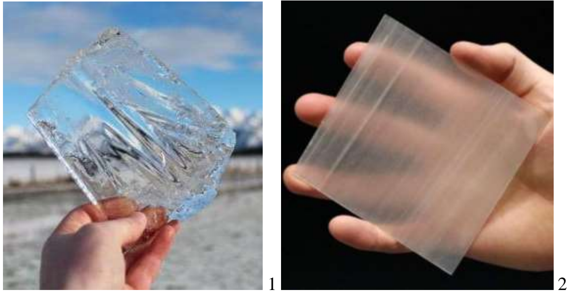
Ілюстрація 20. Поверхні, покриті фотокаталізатором: 1 – прозорий алюміній, 2 – прозоре дерево.
