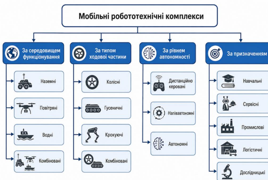
Рисунок 1.1 – Узагальнена класифікація мобільних робототехнічних комплексів за середовищем функціонування, типом ходової частини, рівнем автономності та призначенням [5]
