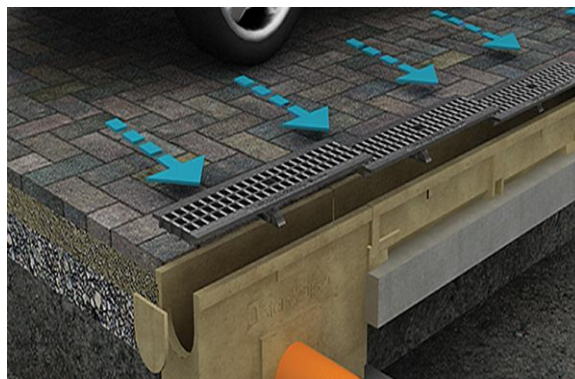
Рисунок 2.2 - Конструкція внутрішнього водостоку будівлі та лотка зовнішньої дощової каналізації
