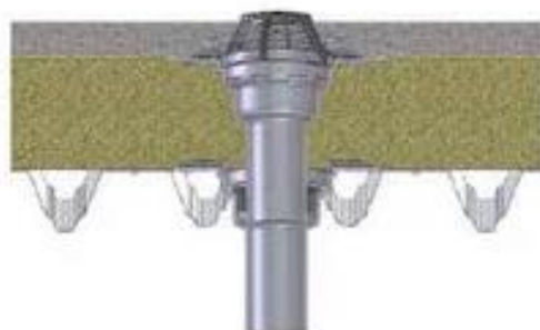
Рисунок 2.2 - Конструкція внутрішнього водостоку будівлі та лотка зовнішньої дощової каналізації
