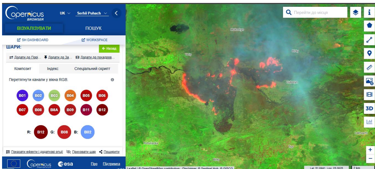
Рисунок 2.8 – Аналіз за допомогою Copernicus Browser пожежі біля с. Бірки, Камінь-Каширського району Волинської області, 2 травня 2025 р. (супутник Sentinel-2, комбінація каналів: B12–B8–B2) [5]
