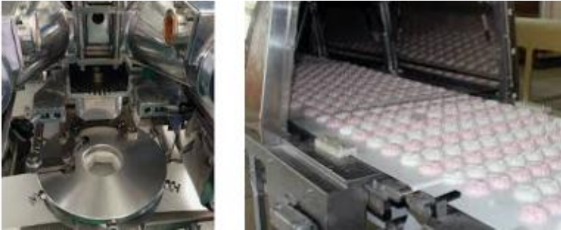
Рисунок 7.7 – Загальний вигляд та робота відсаджувальної машини для зефіру
