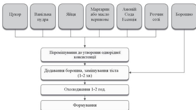
Рисунок 4.4 – Технологічна схема приготування пісочного тіста
