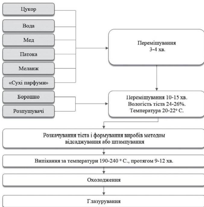
Рисунок 4.9 – Технологічна схема приготування пряників сирцевим способом
