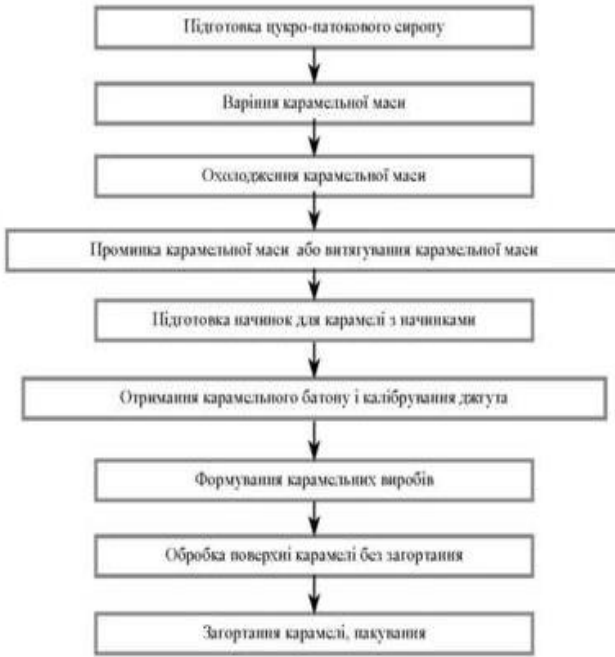
Рисунок 6.1 – Узагальнена схема виробництва карамелі
