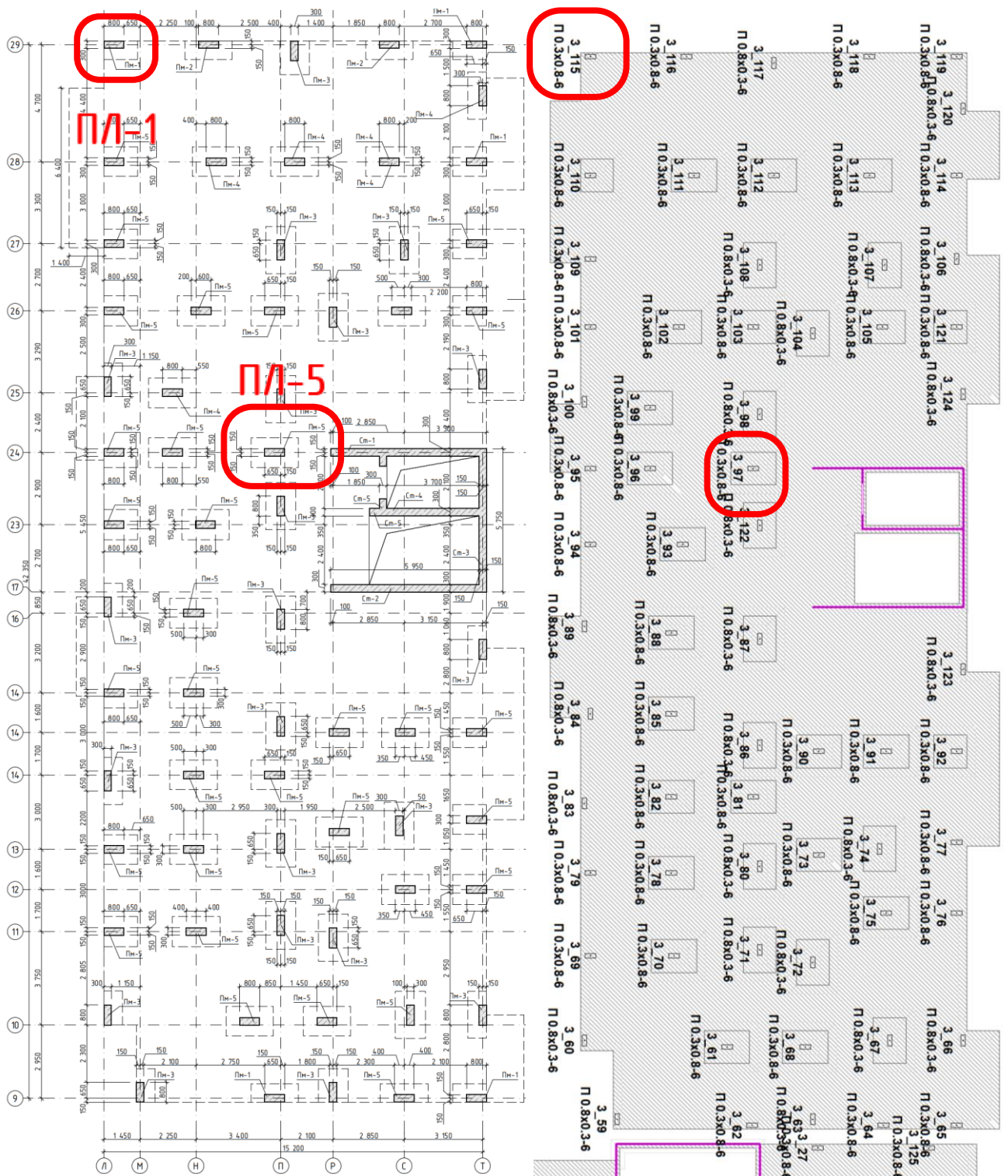
Рис. 2.15 Схеми розташування обраних пілонів на опалубковому кресленні та на виді розрахункової моделі
