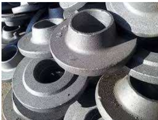
Рисунок 1.5 – Приклади кованих та штампованих виробів з високоміцного чавуну
