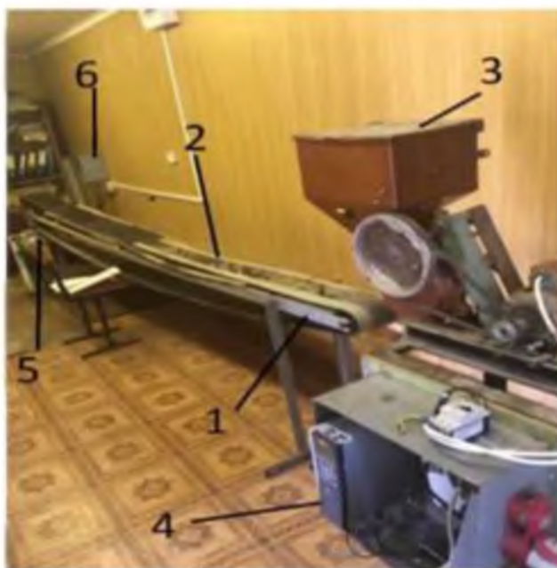
Рисунок 3.2 - Експериментальна установка для посіву насіння цукрових буряків із шириною міжряддя 15 см: 1 - рама установки; 2 - липка стрічка; 3 - висівний апарат; 4 - частотник для приводу стрічки; 5 - мотор-редуктор; 6 - частотник для приводу мотор-редуктора
