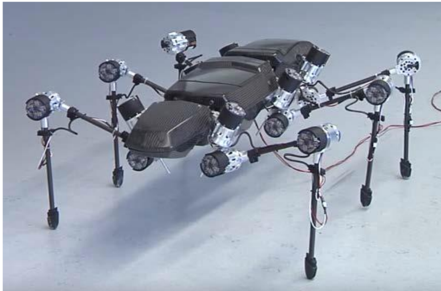
Рисунок 1.12 – Крокуючий робот. Робот-комаха «Nector» [8]
