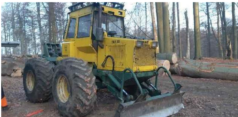
Рисунок 1.2 – Колісний чокерний трелювальний енергозасіб ЛКТ 81 Т (Словаччина)
