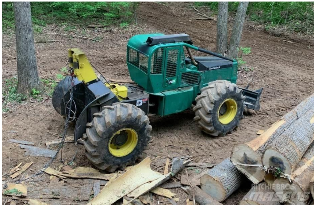
Рисунок 1.1 – Трелювальний енергозасіб Timberjack 240С із чокерним устаткуванням
