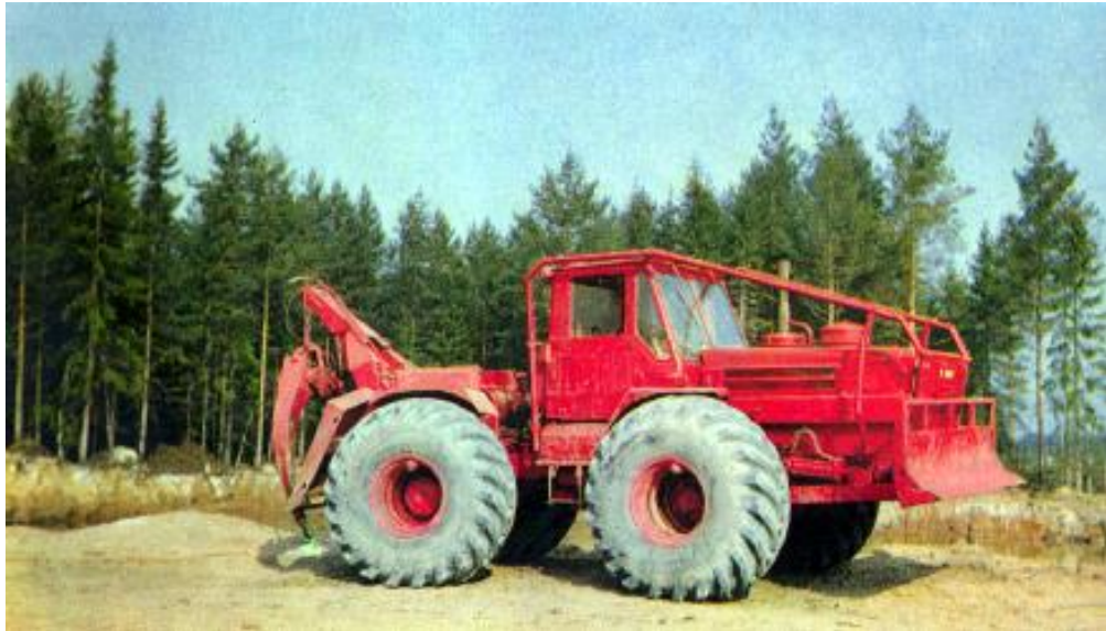
Рисунок 1.4 – Колісний трелювальний агрегат ЛТ-171 з пачковим затискачем
