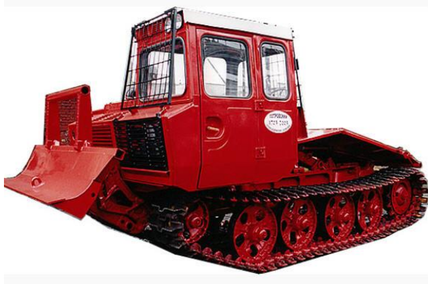
Рисунок 1.7 – Трелювальний енергозасіб ТЛТ-100А гусеничний
