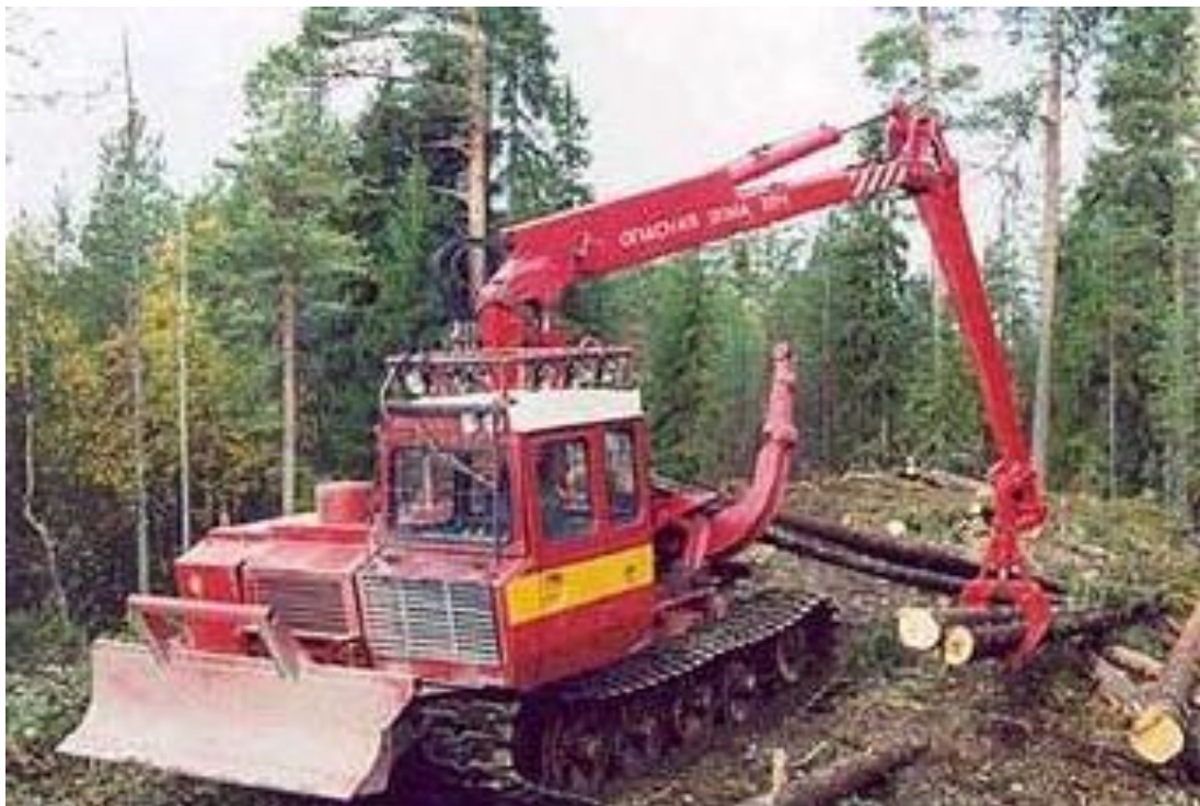
Рисунок 1.6 – Гусеничний трелювальний агрегат ТБ-1М-15 з затискним коником і гідроманіпулятором
