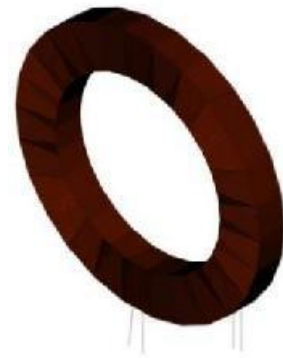
Рисунок 4.25 – Тривимірна модель вторинної обмотки
