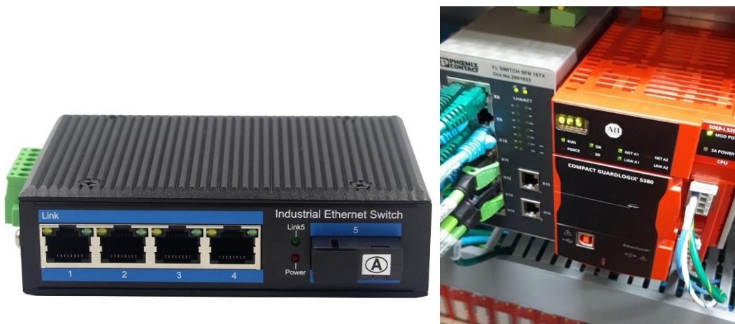
Рисунок 8.2 – LED-індикація портів і модулів
