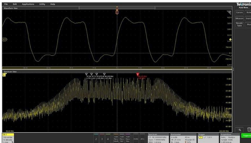
Рисунок 6.2 – Відображення радіосигналу у часовій області на екрані осцилографа
