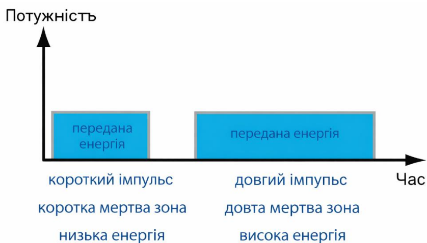
Рисунок 3.6 – Порівняння короткого та довгого імпульсів за енергією, мертвими зонами та досяжною дальністю
