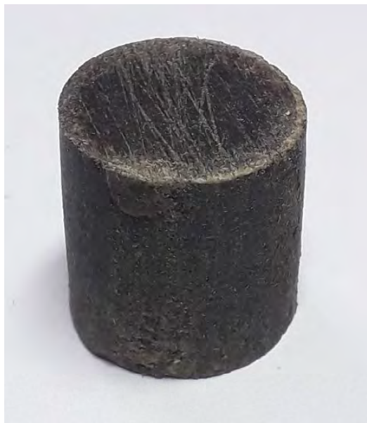
Рисунок 2.4 – Загальний вигляд зразка для визначення міцності на стискання
