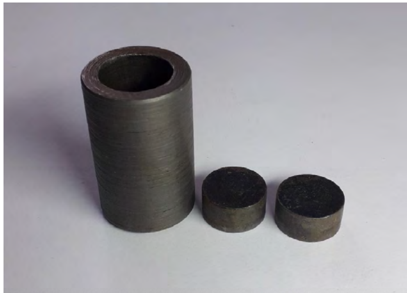
Рисунок 2.7 – Загальний вигляд прес-форми для отримання циліндричних зразків
