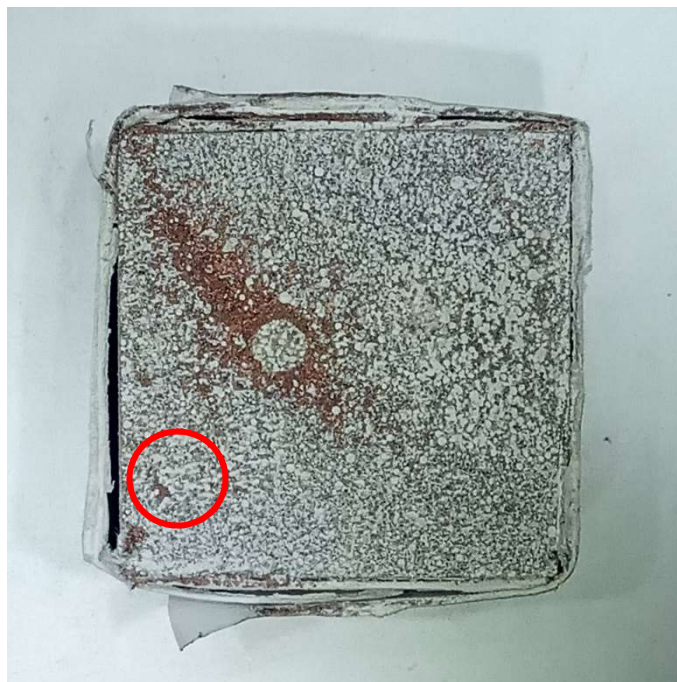
Рисунок 2.5 – Метод виявлення лунки на поверхні епоксикомпозитного зразка
