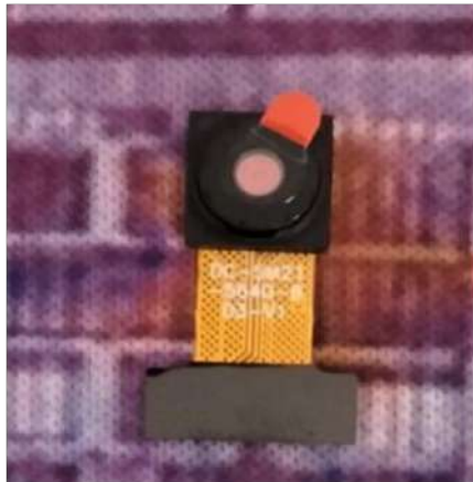
Рисунок 2.5 – Камера OV5640 з 66-градусним кутом огляду
