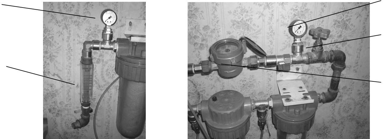
Рисунок 2.2 – Контролюючі органи установки для визначення проникливості: 6 – джерело тиску; 7, 8 – манометри; 9, 10 – датчики.
