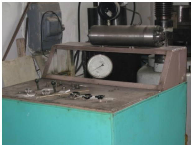
Рисунок 3.3 – Принципова схема (а) та загальний вигляд пресувального комплексу: 1 – пристрій для пресування ППК, 2 – каркас
