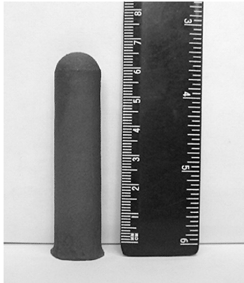
Рисунок 4.2 - Керамічний пористий елемент отриманий СВС-спіканням
