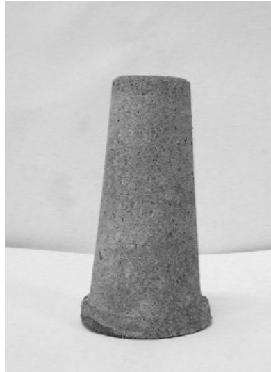
Рисунок 4.11 – Керамічний пористий елемент з нанометричними поверхневими порами (керамічний порошок з відходів керамічного виробництва та порошок карбонільного нікелю марки ПНК–УТ2)
