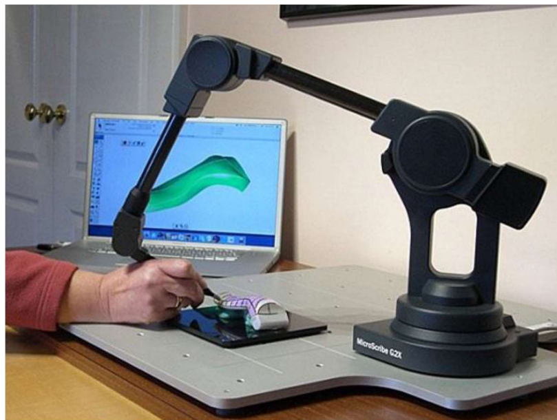
Рисунок 1.4 – Приклад сканування щупом на контактному 3D сканері
