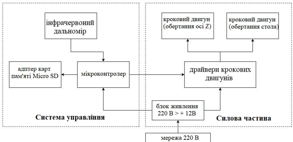
Рисунок 2.1 – Структурна схема пристрою 3D сканера для побудови електричної схеми
