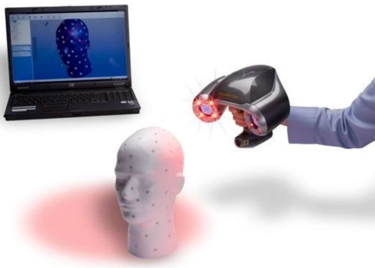
Рисунок 1.5 – Приклад безконтактного активного 3D сканера
