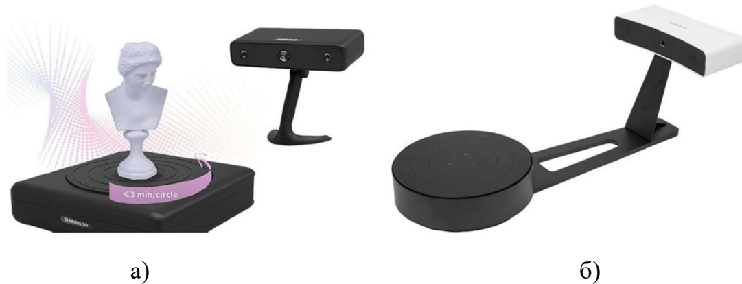
Рисунок 1.15 – 3D сканери Shinning 3D: а) EinScan-S; б) EinScan-SE, які працюють за стереоскопічним методом сканування
