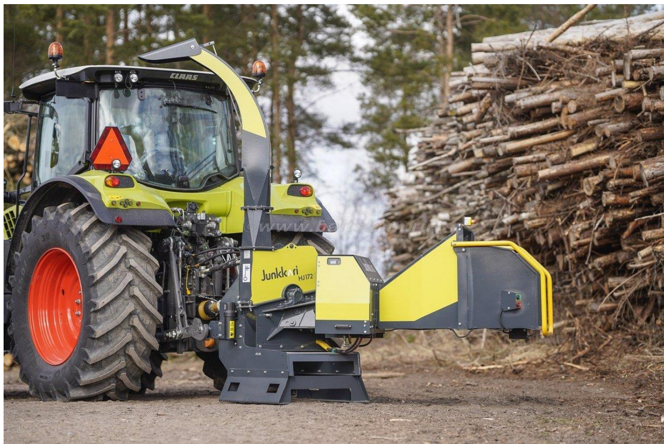
Рисунок 1.4 – Машина навісного типу Junkkari HJ 172 для подрібнення деревини (фінського виробництва)
