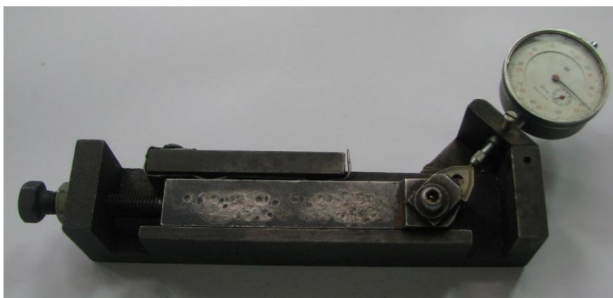
Рис. 14 – Пристій для вимірювання розмірного зношування різця: а – схема, б – загальний вигляд
